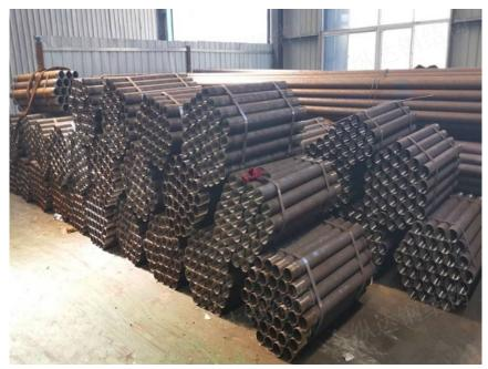
这种方法包括注浆、土壤加固、排水和地层冻结等;预支护法就是在隧道开挖前,先超前对围岩进行加固,以增加围岩的自稳能力,并使开挖面周围应力干扰达到小的方法。超前支护方法主要包括:管棚法,机械预切糟法,预衬砌法,水平旋喷注浆法,超前小导管法,超前锚杆法、冻结法等等。其中管棚法、水平旋喷注浆法、小导管法等支护方法同时也改良和加固了地层。管棚注浆支护:就是把一组钢管沿开挖轮廓外己钻好的孔中打入地层内,并与钢拱架组合形成强大的棚架预支护加固体系,支承来自于管棚上部的荷载,通过钢管的梅花形布置的注浆孔加压向地层中注浆,以加固软弱破碎的地层,提高地层的自稳能力。管棚注浆是一种长距离超前支护方法,超前距离长,刚度较大,适用于掌子面不能自稳、含水的地层,控制地表沉降、防渗止水的效果较好,施工工艺要求较高。如将管棚注浆与小导管补充注浆法结合,除具有大管棚的特点外,能够防止管棚下方三角土体的塌落,这种长短结合的预支护效果更为理想。管棚支护的主要作用和优点:(1)梁拱效应:先行施设的管棚,以掌子面和后方支撑为支点,形成一个梁式结构,二者构成环绕隧洞轮廓的壳状结构,可有效围岩松动和垮塌。。
